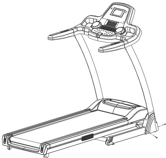
Siga la punta de la flecha y coloque el acabado en la estructura inferior. Fije el acabado con dos tornillos (ST4x20) a cada lado. Instalación completa.
